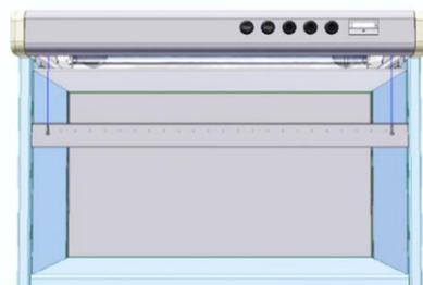
4. Acrylglas an der Rückwand auflegen, Blende an der Lampe anschrauben.
